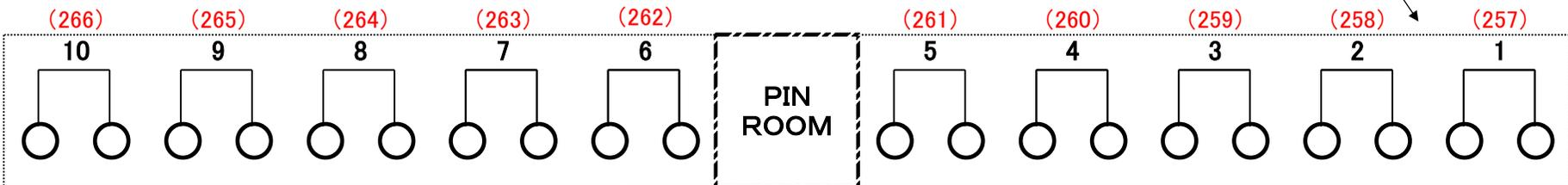
2kw凸 × 20台 \* 10インチ (C型/40A 10回路) (予備器材 ECLQ-8Z-2KW 10インチ × 4台)
